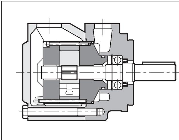
— Die DFP Pumpen sind Flügelzellenpumpen mit konstantem Hubvolumen, die in vier verschiedenen Größen hergestellt werden. Diese Größen sind dann in fünf verschiedenen nominalen Hubvolumen unterteilt.
