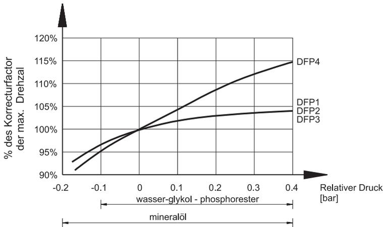
Wenn der Druckwert in der Saugleitung anders als Null ist, soll der in der Tabelle 3 gezeigte Höchstdrehzahlwert mit dem Korrekturfaktor multipliziert werden, der von diesem Diagramm angegeben wird.
