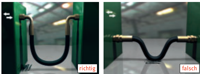
Abbildung 9: Vermeidung von Abrieb durch ausreichende Bewegungsfreiheit
