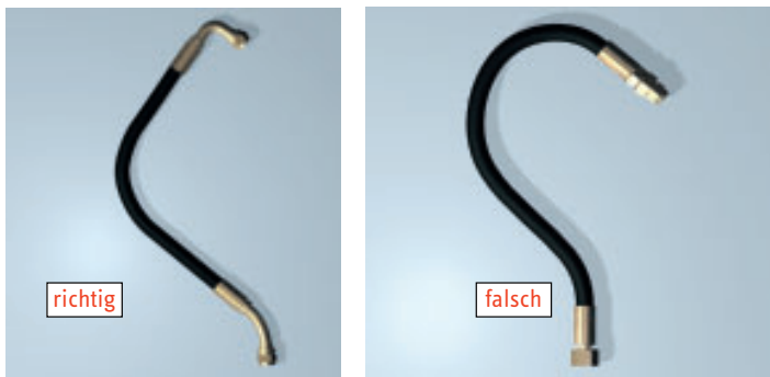
Abbildung 6: Einbau mit Bogenarmatur / ohne Bogenarmatur
