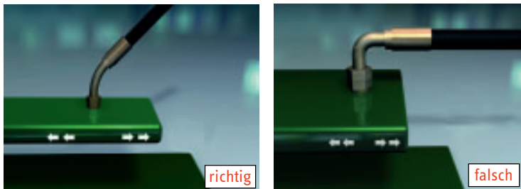
Abbildung 15: Verlegung bei Schwingungen
