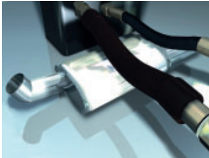
Abbildung 14: Schlauchleitung mit und ohne Hitzeschutz
