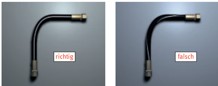
Abbildung 5: Torsion beim Einbau
